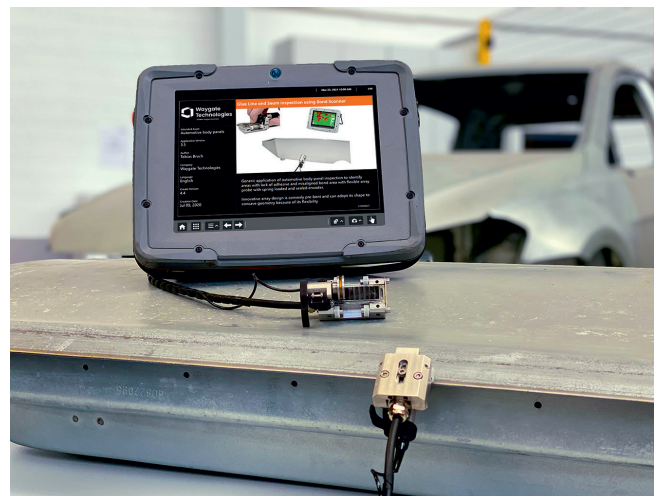
Bild 3. Prüfung von Klebeverbindungen in der KFZ-Industrie mit Krautkrämer Mentor UT Fehlerprüfgerät und Bondscanner. © Waygate Technologies
